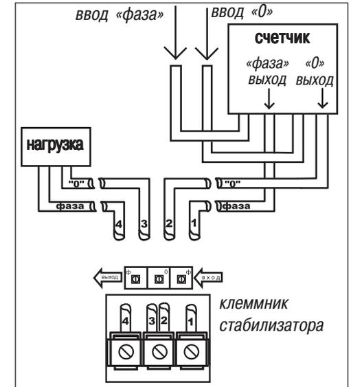
Рис. 17. Схема установки
