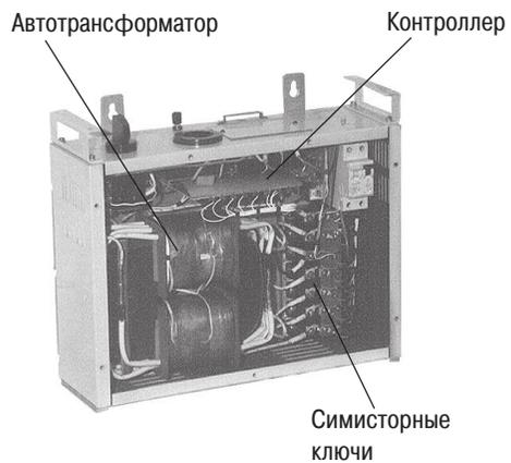
Рис. 8. Устройство стабилизатора
