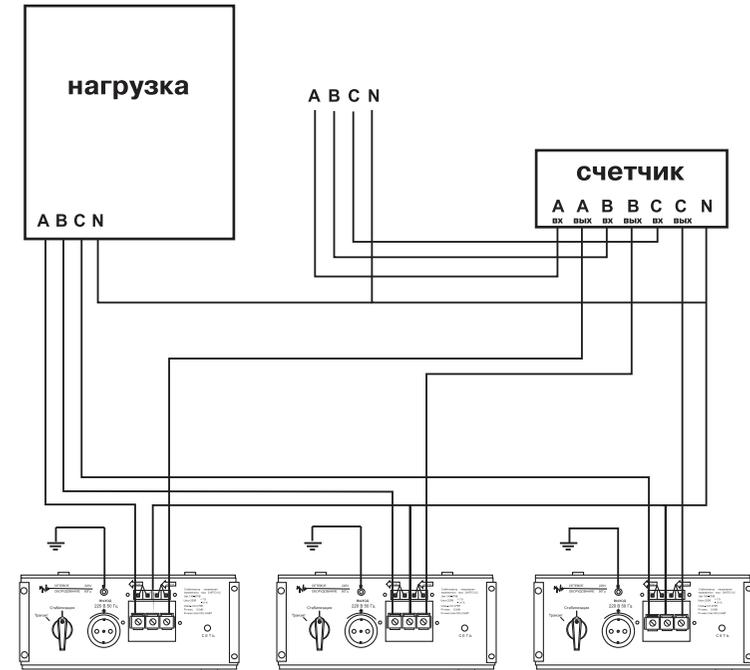
Рис. 18. Схема подключения стабилизаторов к трехфазной сети
